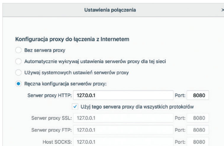
Rysunek 6. Konfiguracja ustawień proxy w przeglądarce Mozilla Firefox
